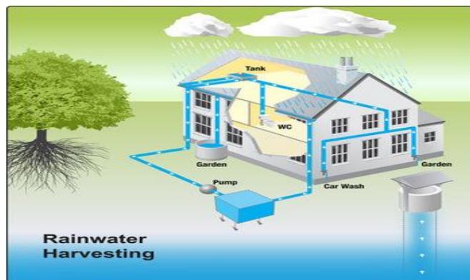
**Gambar 8.** Distribusi air bersih dari atap bangunan ke sumur PAH.
