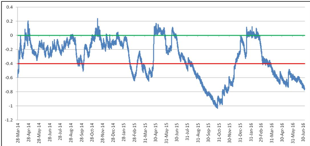
**Gambar 2.** Fluktuasi *water table* dengan pengaturan tinggi bendungan 0,4 meter dari permukaan gambut (Sumber: PT RAPP 2017).
