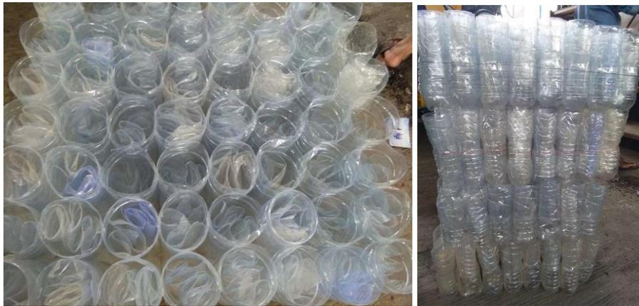
**Gambar 4.** Biofilter anaerob dari plastik PET.
